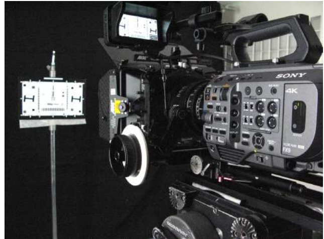
Pruebas de resolución con la carta ISO 12232
